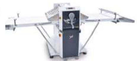
LAMINATO 650 Μήκος κυλίνδρου: 65cm Μήκος τραπεζιού: 310cm 1100 Watt, Τριφασικό
