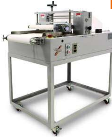
HS-3S Απόσταση μεταξύ μαχαιριών: 5-13,5 cm 420 Watt Μονοφασικό
