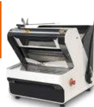
PRIMO επιτραπέζιο χειροκίνητο μηχανήμα 640x644x730 mm πάχη κοπής φέτας: 9 - 16 mm πλάτος κοπής άρτου: 44x30x17 cm ισχύς: 370 Watt Τριφασικό
